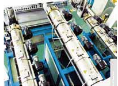
多層共擠流延膜設備
